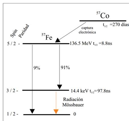
El espectro gamma de una fuente de  $^{57}\text{Co}$  en una matriz de Rh se caracteriza principalmente por fotopicos en 6, 14.4, 20, 122 y 136 keV superpuestos con un ancho y continuo fondo debido principalmente al efecto Compton de los fotones de mayores energías. Pueden aparecer otros fotopicos debido a rayos X del material circundante al experimento, por ejemplo plomo.
